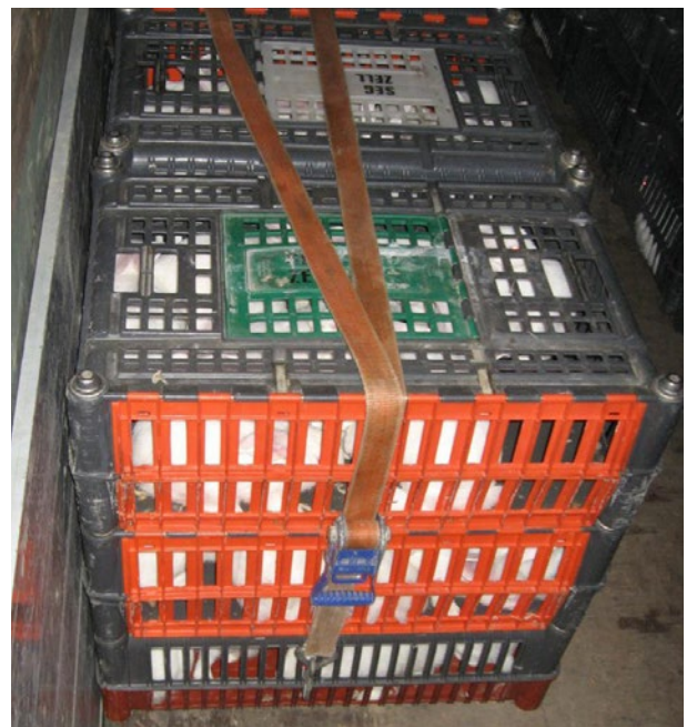
Sicherung der Transportkisten mit Spanngurten.
